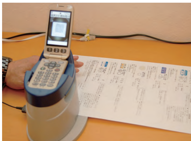
▲写真1 薬剤情報提供書の隅に印刷してある音声コードを、携帯電話で読み取ると、薬の説明が音声化される。
