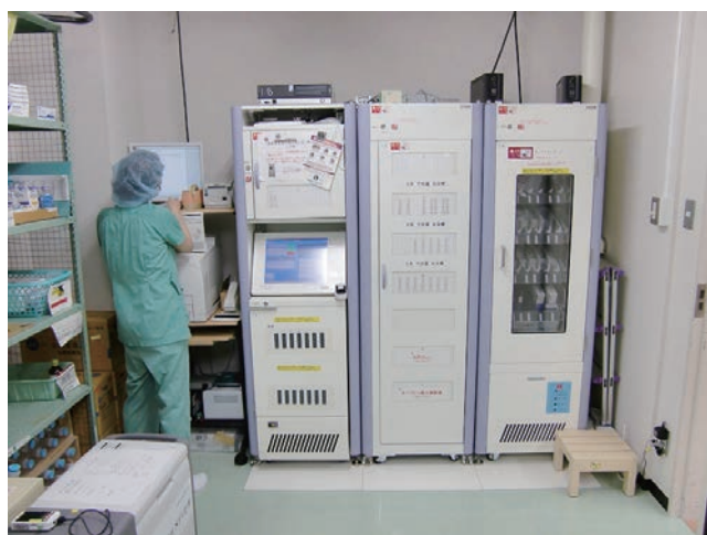
▲写真 医薬品を指静脈認証で厳重管理するリアルタイム薬品管理装置『LITERA（リテラ）』。夜間麻薬金庫と併用することで、薬剤師による規制医薬品の24時間一元管理が可能となった。
