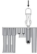
吐出後、検体ピペットを抜き取り、3本のピペットチップが落ちないように指で押さえながら試薬カートリッジを横に振り、血液と検体希釈液をよく混合します。
